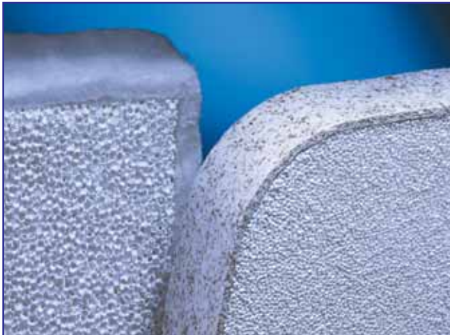
Ceralu-Filter mit keramischer Faser-Dichtung (li) und mit expandierender Dichtung (re)
